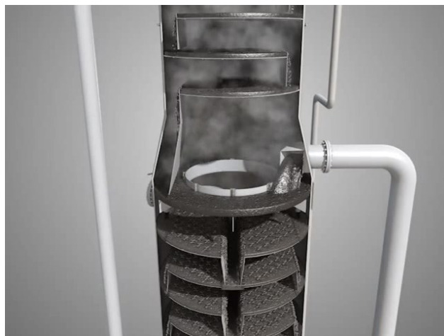
6-расм. “Ректификацион колонна” видеоинструкторидан лавҳа
